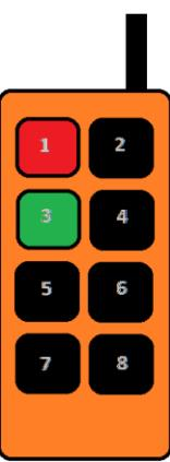
Комплект состоит из радиопульта, который при работе находится у оператора механизма, и приемника сигналов, который подключен к подъемному устройству и в котором срабатывают соответствующие реле.
